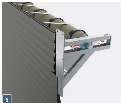
5 Ruchomy wał – w trakcie nawijania kurtyny zmienia swoje położenie względem ściany nadproża, zapewniając w ten sposób utrzymanie w osi prowadnic poruszającej się kurtyny.
